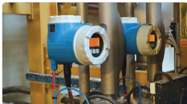
Obr. 2 Hmotnostný prietokomer Promass 83F stráži správny pomer alkoholu vo whisky
