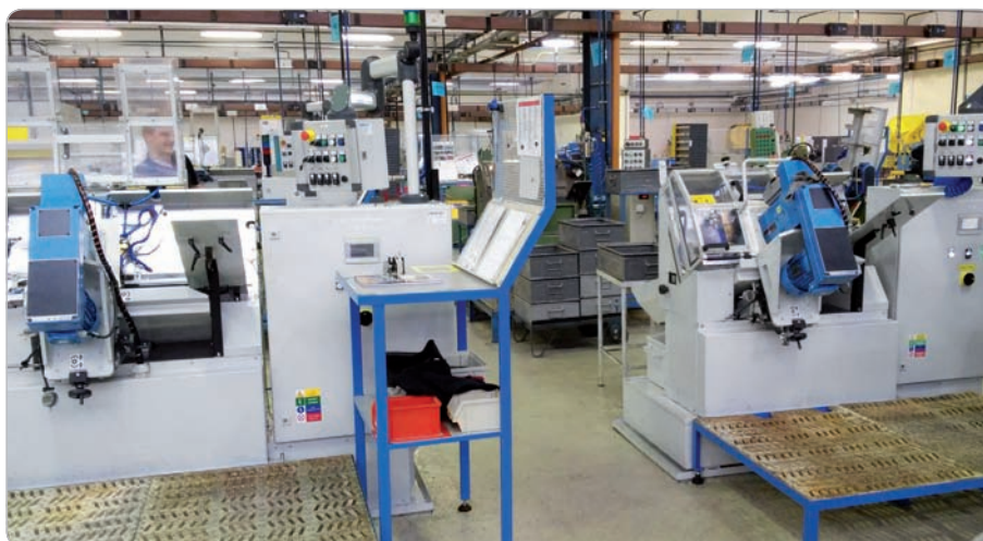
Obr. 1 Dve zrážачky hrán axiálnych ložísk v prevádzke v spoločnosti MAHLE Engine Components Slovakia, s. r. o., v Dolnom Kubíne
